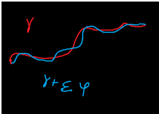
Figur: Kurva och variation av kurva. Notera att ändpunkter är fästa.
